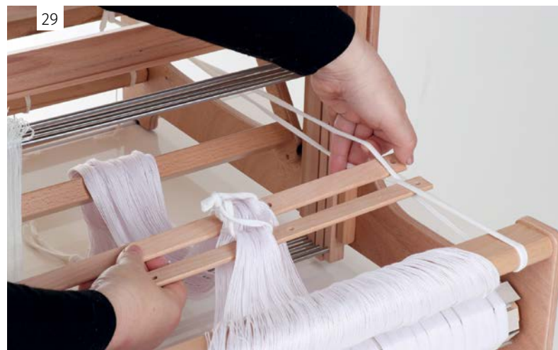
29 Pour soutenir les baguettes d'encroix, utilisez les bandelettes élastiques, croisées en huit.
